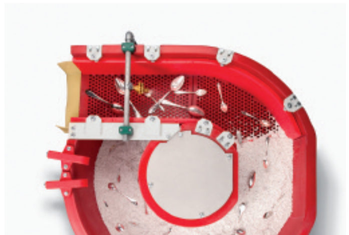
Spülbehälter einer BRA-Anlage von oben
