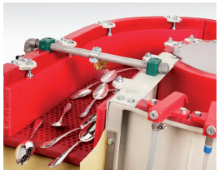
Klarspülzone einer BRA-Anlage
