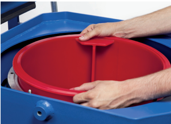
Einfacher Wechsel des Schlammkorbes ohne Werkzeuge
