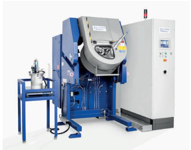
Der Rotamat R 60 beschichtet additiv gefertigte Teile gleichmäßig mit Lack. Er wurde speziell für kleine Chargen mit geringen Stückzahlen entwickelt, die in der additiven Fertigung nicht unüblich sind (Bilder: Walther Trowal GmbH & Co. KG, Haan)
