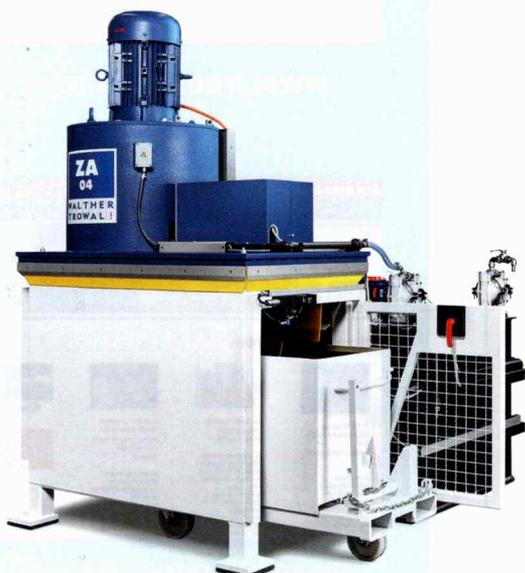
Die neue Schälzentrifuge ZA 04 arbeitet weitestgehend automatisch und nimmt nur wenig Hallenplatz in Anspruch. Alle Bedien- und Wartungselemente sind von derselben Seite her zugänglich
