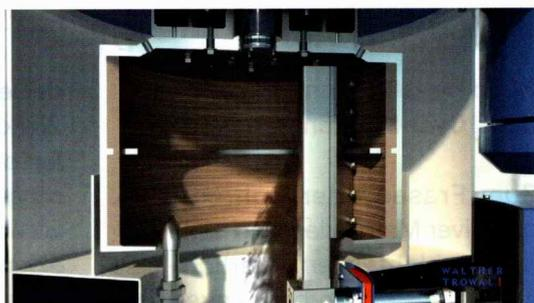
Der digitale Schaber entfernt den Schlamm von der Innenseite der rotierenden Trommel
