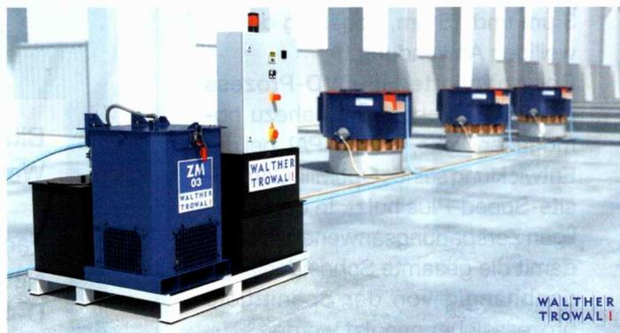
Schälzentrifugen (links) recyceln das Prozesswasser von Rundvibratoren (rechts) für das Gleitschleifen (Bilder: Walther Trowal)
