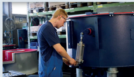
Die Endmontage eines neu ausgekleideten Behälters
