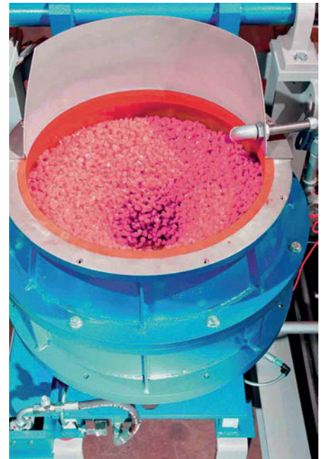
Beim Gleitschleifen unterliegt die Auskleidung des Arbeitsbehälters naturgemäß beträchtlichem Verschleiß
