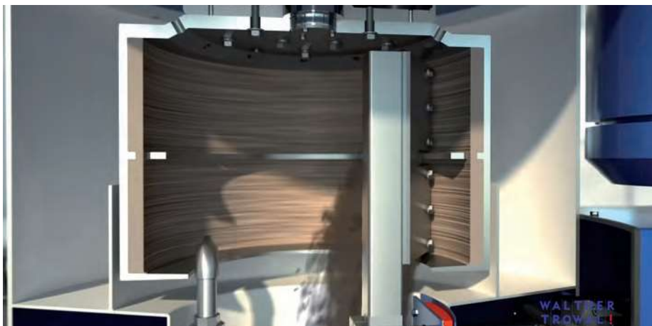
Der digitale Schaber entfernt Schlamm von der Innenseite der Trommel (Bild: Walther Trowal)
