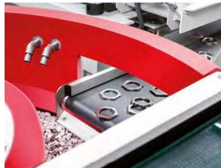
Die Werkstücke werden über ein Förderband von der Seite zugeführt (Bild: Walther Trowal)
