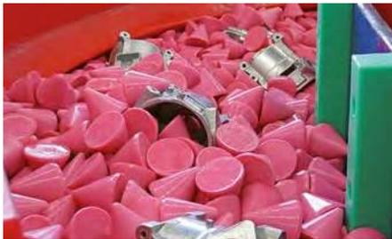
**Druckgussteile im Schleifkörperbett**
