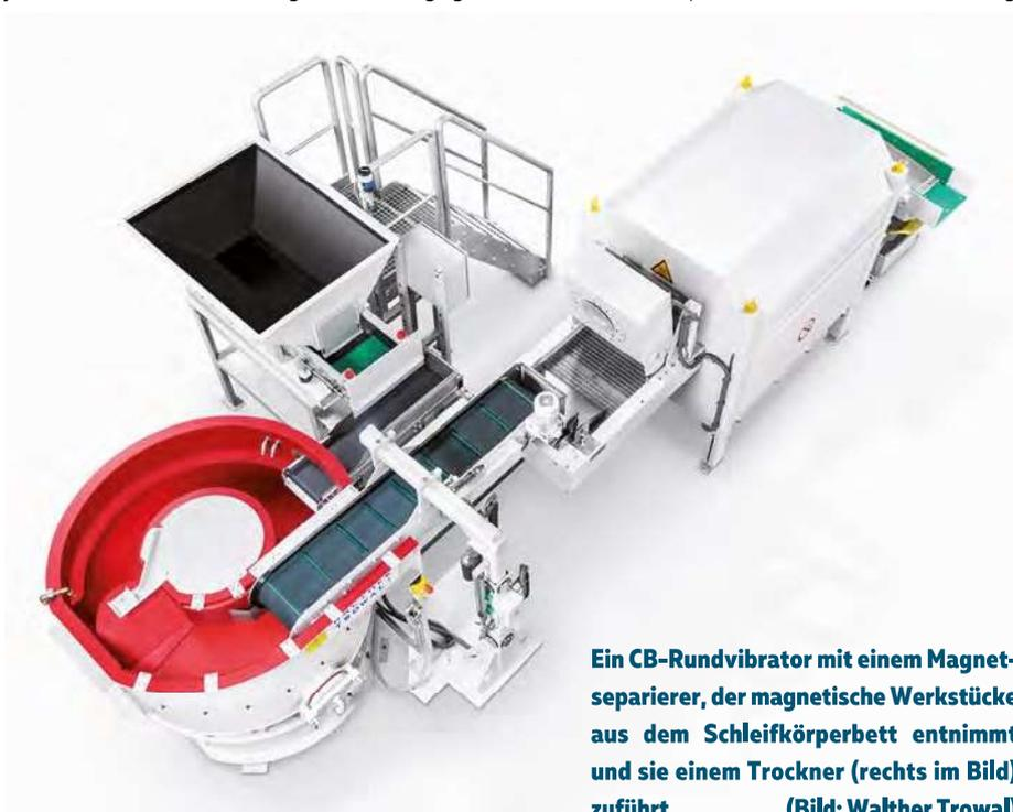
Ein CB-Rundvibrator mit einem Magnetseparierer, der magnetische Werkstücke aus dem Schleifkörperbett entnimmt und sie einem Trockner (rechts im Bild) zuführt (Bild: Walther Trowal)
