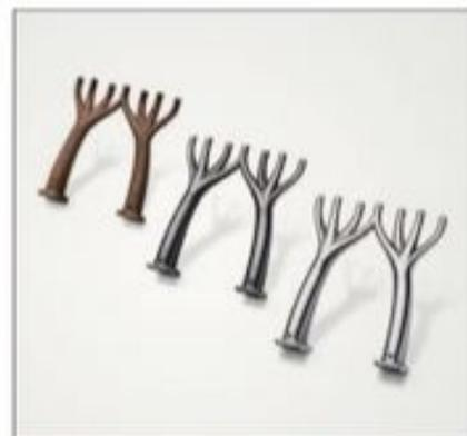
Eine additiv gefertigte Düse vor (links) und nach dem Schleifen (Mitte) sowie nach dem Polieren (rechts).
