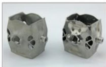
Ein additiv gefertigter Kardanrahmen vor (links) und nach dem Trowalisieren (rechts).
