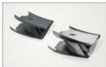
Ein additiv gefertigtes Luftleitblech vor (links) und nach dem Trowalisieren (rechts).
