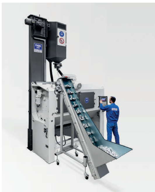
Muldenband-Strahlanlage THM 300/1: Mit einer Grundfläche von nur 1,4 x 2,7 m lässt sich die Maschine leicht in Produktionslinien integrieren
