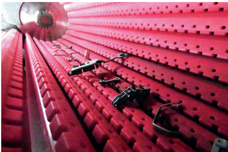
Muldenband-Strahlanlage THM 300/1: Das Muldenband fördert die einzelnen Teile schonend
