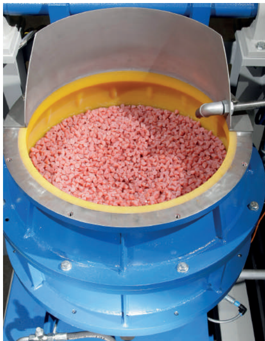
Die Schleifkörper und die Werkstücke bewegen sich an der Innenwand des Arbeitsbehälters nach oben und fallen anschließend auf den Drehteller zurück (Bilder: Walther Trowal GmbH & Co. KG, Haan)
