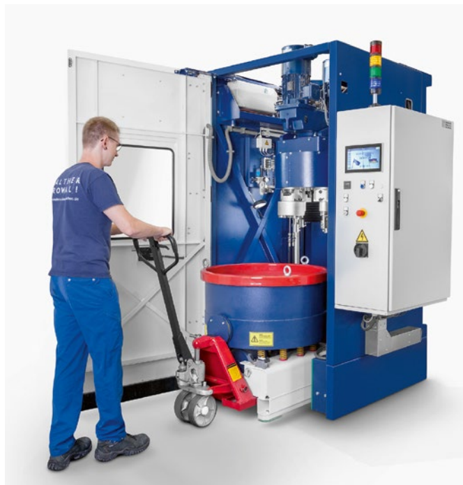
Ein Werkstück kurz vor dem Absenken in das Schleifmedium.
