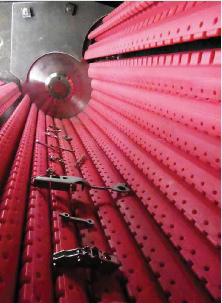
*Das Muldenband-Prinzip: Die Werkstücke in der Mulde rollen sanft auf der Polyurethan-Beschichtung der Muldenstäbe ab. Sie kollidieren nicht miteinander, sondern touchieren höchstens leicht. Foto: Walther Trowal*
