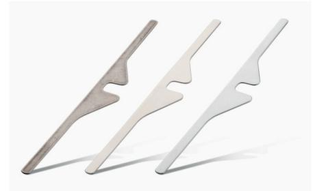
**Eine 0,15 mm dicke Webplatine vor (links) und nach (rechts) der Bearbeitung in der Turbotron-Anlage**
