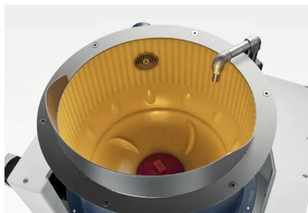
**In den neuen TT-Fliehkraftanlagen wird der Spalt zwischen dem Drehteller (unten) und dem Arbeitsbehälter (oben) gespült**
