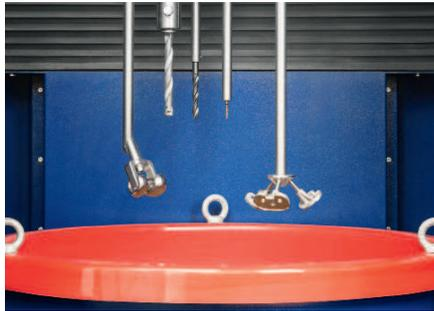
Die Satelliten der neuen Schleppschleifanlage nehmen bis zu 18 Teile auf, nur für dieses Foto wurden unterschiedliche Werkstücke eingespannt.
