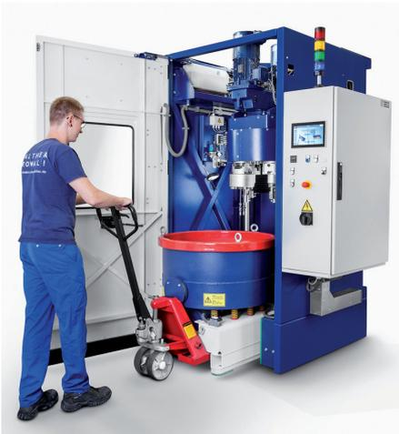
**Alle Prozessschritte in der selben Maschine, die kompakt ist und wenig Platz beansprucht: Ein Arbeitsbehälter wird mit einem Handhubwagen aus der Maschine gezogen und innerhalb kürzester Zeit durch einen ersetzt, der andere Schleifkörper enthält**
