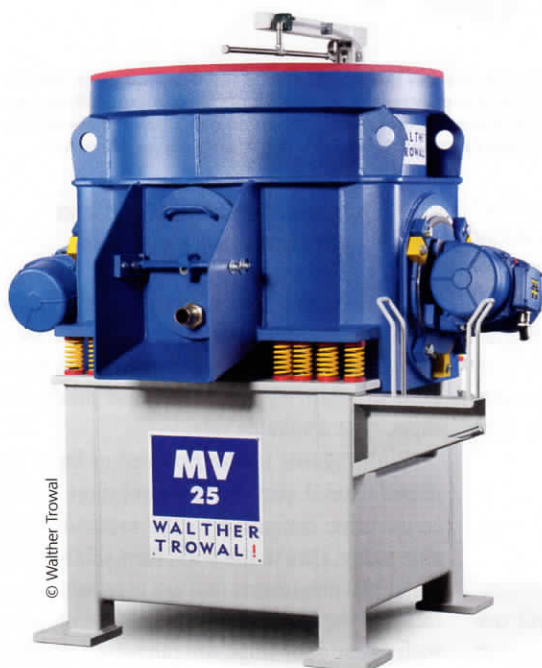
Die MV-Multivibratoren werden von hochtourigen Unwuchtmotoren angetrieben. Durch die Überlagerung der hochfrequenten Schwingungen entsteht ein sehr gleichmäßiges Schliffbild.
