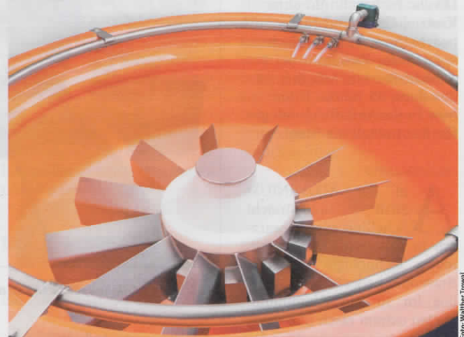
Das Gleitschleifen mit Rundvibratoren erzielt auch bei der Oberflächenbehandlung von Blisks – hier ein Dummy – für Flugzeugtriebwerke exzellente Ergebnisse
