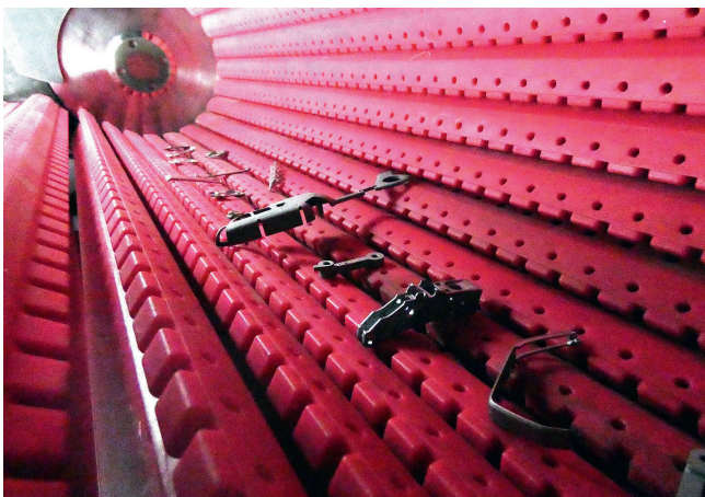
Schonende Teileförderung mit der Muldenband-Strahlanlage THM 300/1 © Trowal
