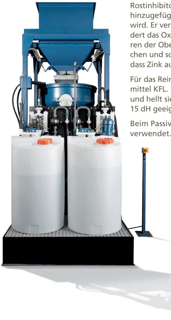
Die einzelnen Compounds werden dem jeweiligen Prozessschritt entsprechend automatisch dosiert und in den Arbeitsbehälter gefördert.
