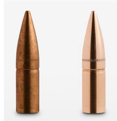
Rohlinge und fertige Projektile vor (links) und nach (rechts) der Bearbeitung im Rundvibrator
