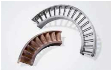
Ein additiv gefertigtes Blisk-Segment vor (links) und nach dem Trowalisieren
