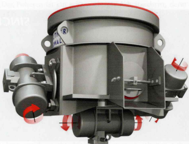
Drei Unwuchtmotoren versetzen den Behälter in Vibration. © Walther Trowal
