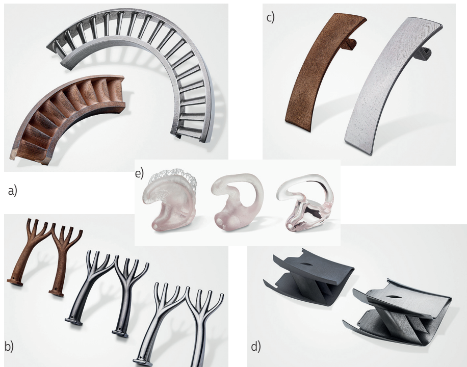
a) Ein additiv gefertigtes Blisk-Segment vor (l.) und nach dem Trowalisieren; b) eine additiv gefertigte Düse vor (l.) und nach dem Schleifen (Mitte) sowie nach dem Polieren; c) ein additiv gefertigter Clip vor (l.) und nach dem Trowalisieren; d) ein additiv gefertigtes Luftleitblech vor (l.) und nach dem Trowalisieren; e) ein additiv gefertigtes Ohr-Einpasseselement vor (l.) und nach dem Trowalisieren (Mitte) sowie nach dem Polieren (Bilder: Walther Trowal)
