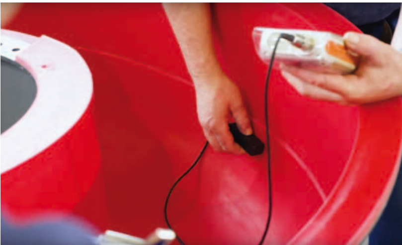
Die Dicke der neuen Auskleidung wird geprüft und dokumentiert.
