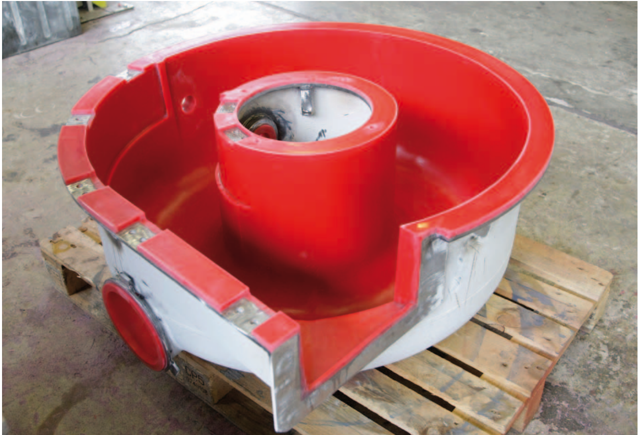
Ein neu ausgekleideter Arbeitsbehälter vor dem Lackieren
