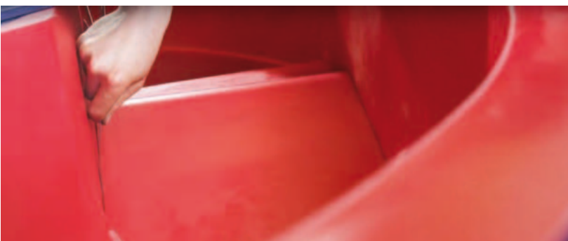
Am Ende des Prozesses werden auch die Spaltmaße geprüft.
