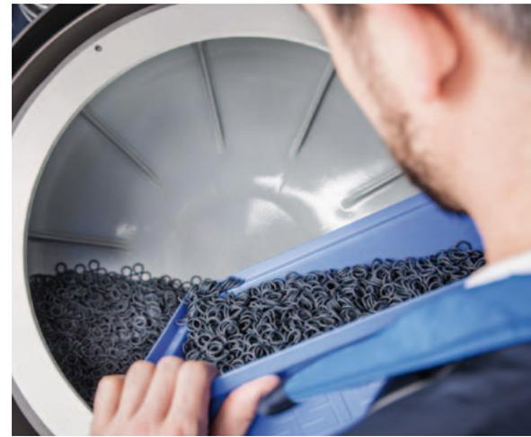
Der Rotamat eignet sich für das Beschichten von Massenkleinteilen, zum Beispiel aus Elastomeren (Foto) oder Metall.
