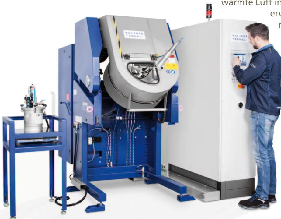
In Abhängigkeit von den Werkstoffeigenschaften der Teile und/oder der Lacke stattet Walther Trowal alle neuen Maschinen mit einer getakteten und einer PID-Regelung des Heizregisters aus. Zwischen beiden kann bei Bedarf über die Software der Anlagensteuerung gewechselt werden.
