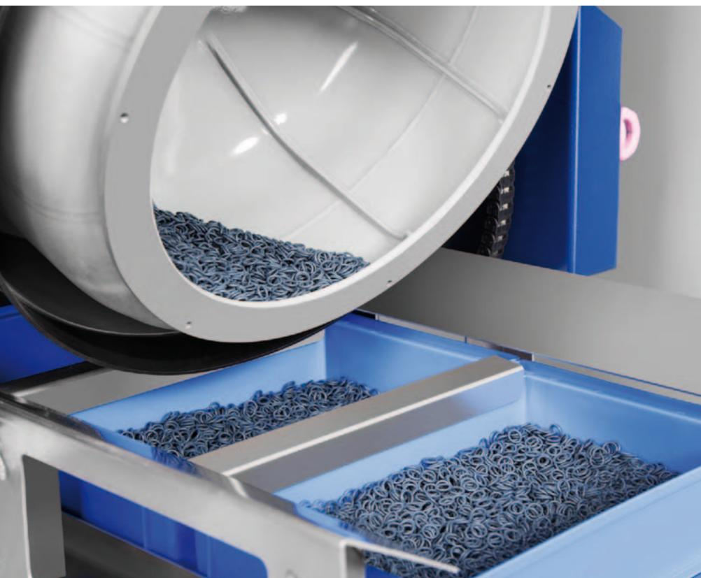
Für das Entleeren schwenkt ein Pneumatikzylinder die Trommel nach unten.
