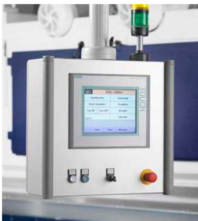
Bedienpanel einer THM-Strahl-anlage mit Touch-Bildschirm
