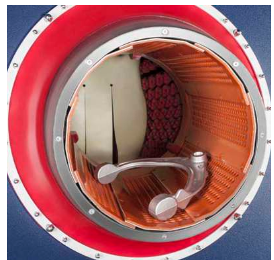
Werkstücke in der Durchlaufmulde (Bild oben) und in der Auslauf-Siebtrommel (Bild unten)
