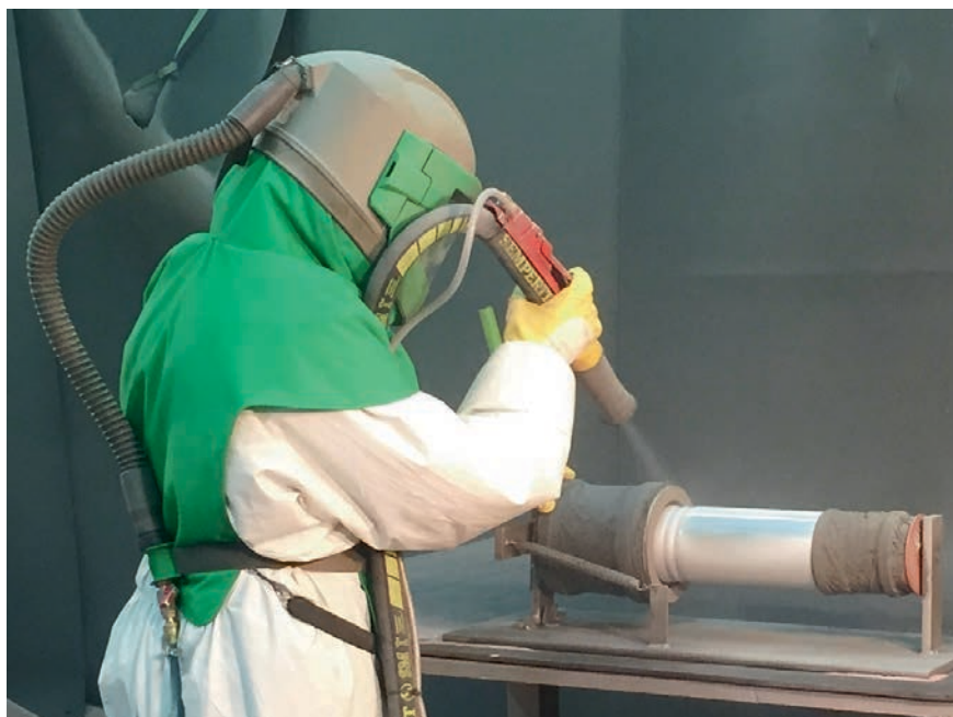
Strahlstaub und Lärm dominieren die Arbeitsbedingungen in der Strahlkabine – daher der Wunsch nach stärkerer Automatisierung.
