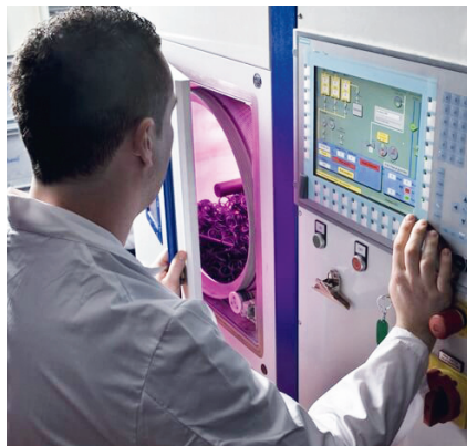
Der Prozess wird von einem in den Schaltschrank integrierten Industrie-PC mit Touchpanel gesteuert und überwacht.
