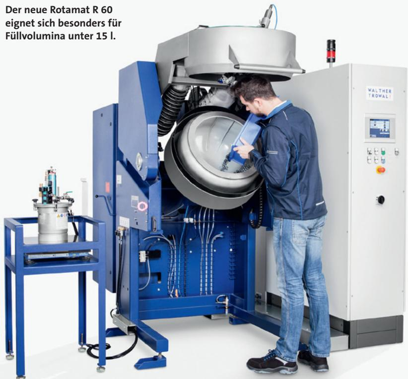
steuert, sodass eine hohe Reproduzierbarkeit erreicht wird. Durch die integrierte Reportverwaltung können alle in der Vergangenheit gelaufenen Prozesse wieder aufgerufen und die Parameter der einzelnen Chargen genau nachvollzogen werden.
