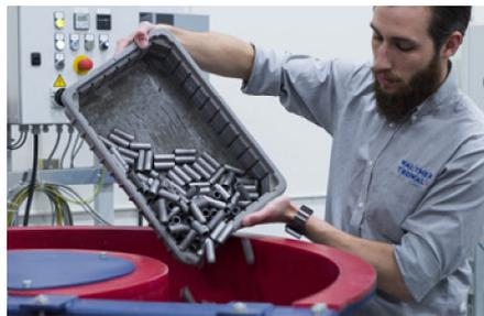
**Im Labor des Test & Training Centre: Befüllen eines CF-Rundvibrators für das Gleitschleifen**
