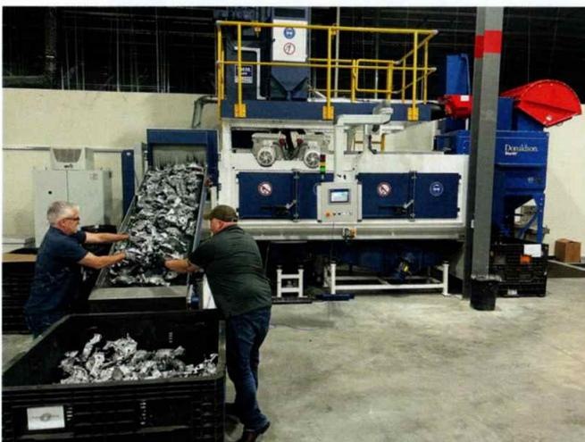
Eine Strahlanlage THM 400 wird im TTC Test and Trainingcenter in Grand Rapids/USA mit Aluminium-Druckgussteilen für die Automotive-Industrie beladen (Bilder: Walther Trowal)
