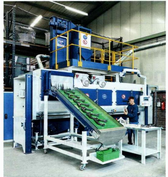
Große Durchlaufstrahlanlagen mit mehreren Turbinen arbeiten bisher stets mit einem Überschuss von Strahlmittel im Kreislauf, um sicherzustellen, dass alle Teile perfekt gestrahlt werden.
