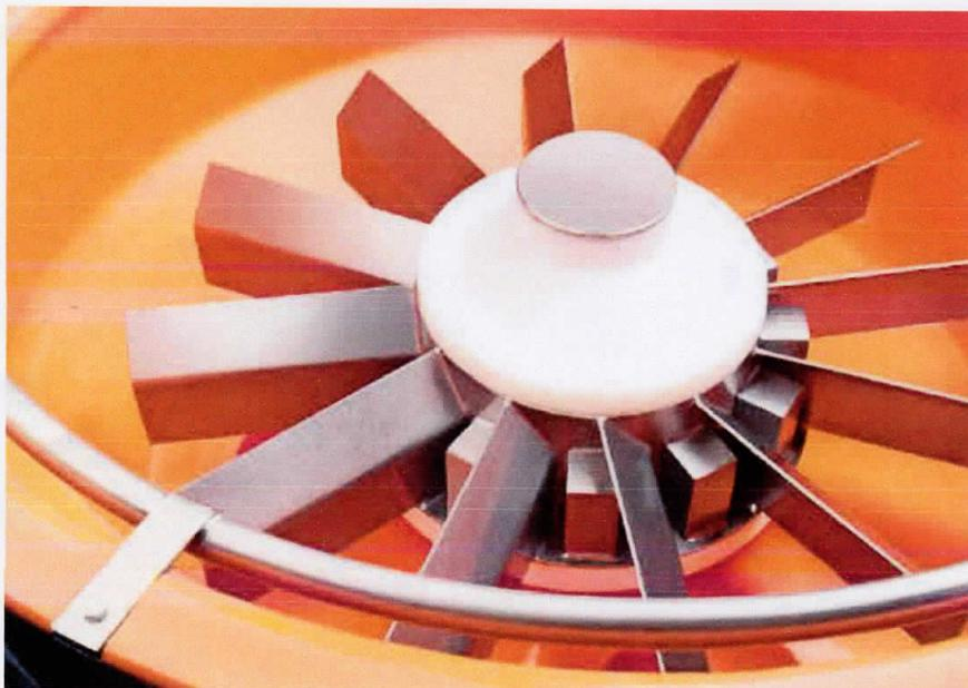
Der Arbeitsbehälter des CM Rundvibrators – für das Foto mit einem Dummy bestückt.
