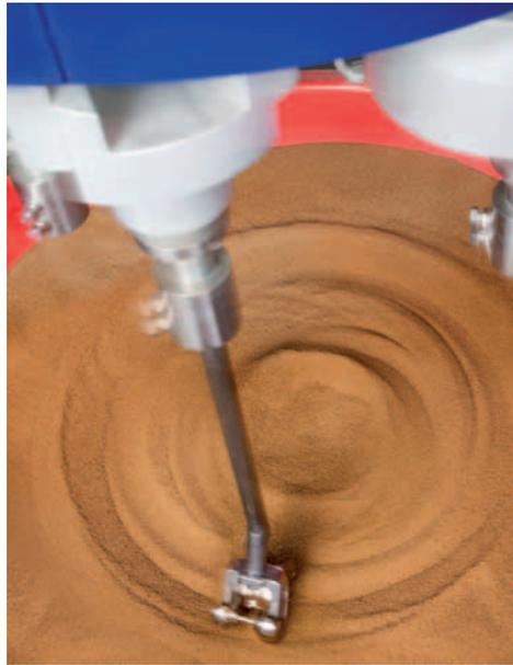
In der Abbildung sieht man ein Werkstück kurz vor dem Absenken in das Poliermedium.
