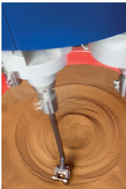
**Bild 2:** Ein Werkstück kurz vor dem Absenken in das Poliermedium
