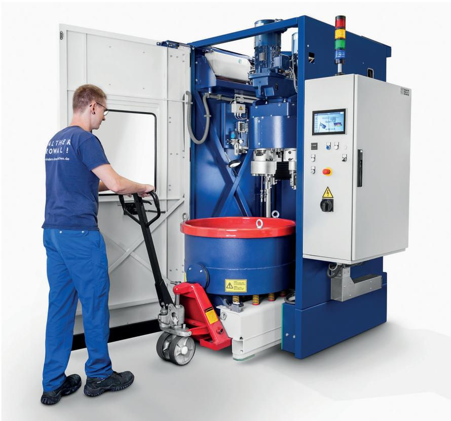
Bild 4: Alle Prozessschritte in derselben Maschine: Ein Arbeitsbehälter wird mit einem Handhubwagen aus der Maschine gezogen und innerhalb kürzester Zeit durch einen ersetzt, der andere Schleifkörper enthält
