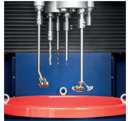
**Bild 3:** Die Satelliten der neuen Schleppschleifanlage nehmen bis zu 18 Teile auf, nur für dieses Foto wurden unterschiedliche Werkstücke eingespannt
