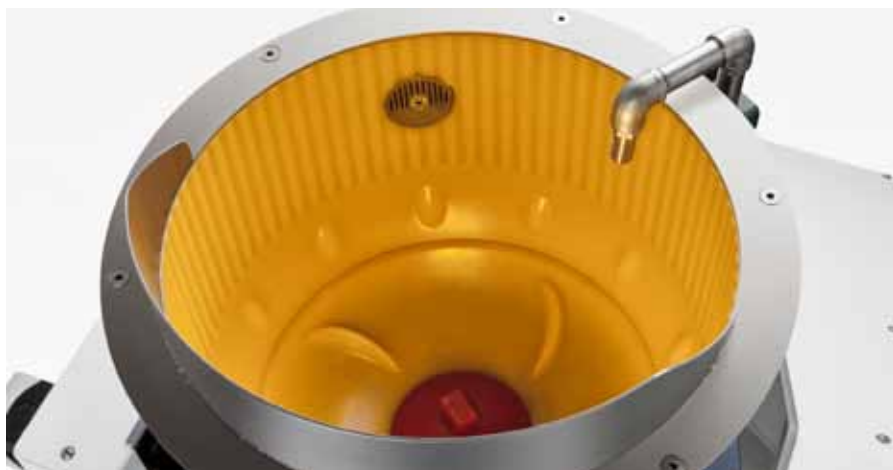
In den neuen TT-Fliehkraftanlagen von Walther Trowal wird der Spalt zwischen dem Drehteller (unten) und dem Arbeitsbehälter (oben) gespült.
