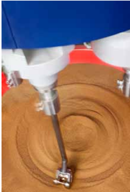
Ein Werkstück kurz vor dem Absenken in das Schleifmedium.
