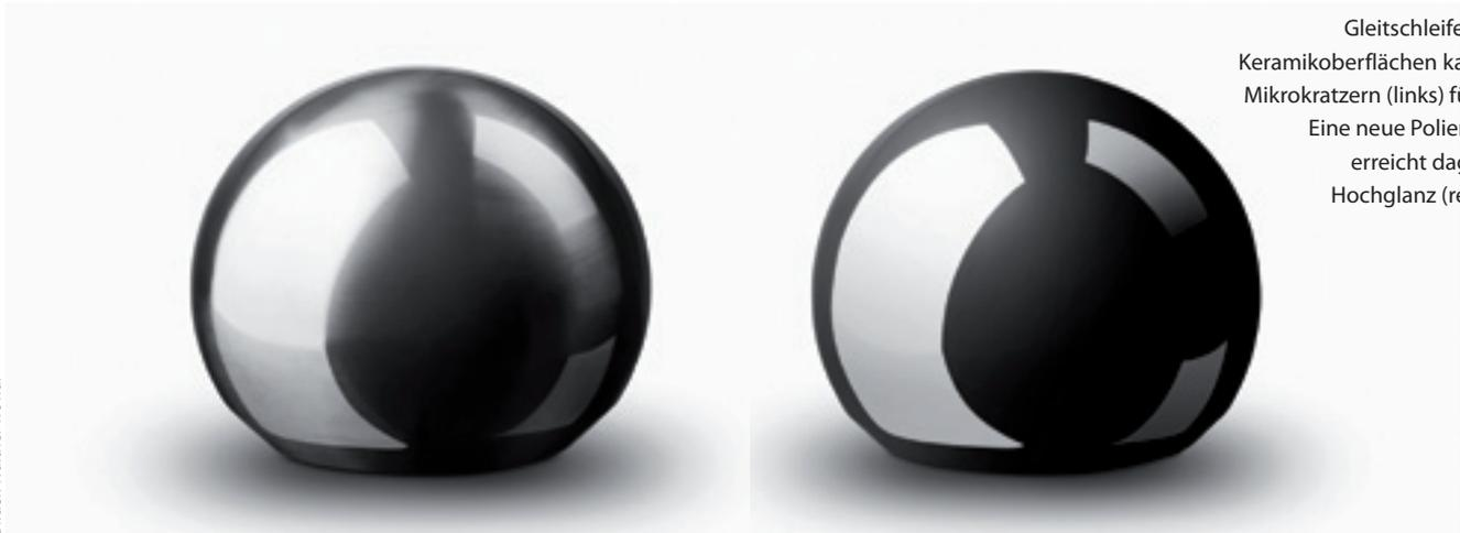
Gleitschleifen von Keramikoberflächen kann zu Mikrokratzern (links) führen. Eine neue Polierpaste erreicht dagegen Hochglanz (rechts).
